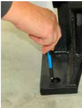
图 8a 标记钻孔
