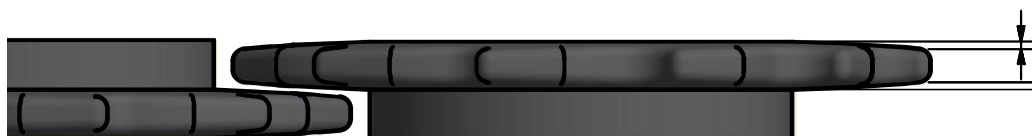
Desgaste de la cuchilla
