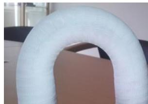
Bild 4: 180°-Biegeprüfung
