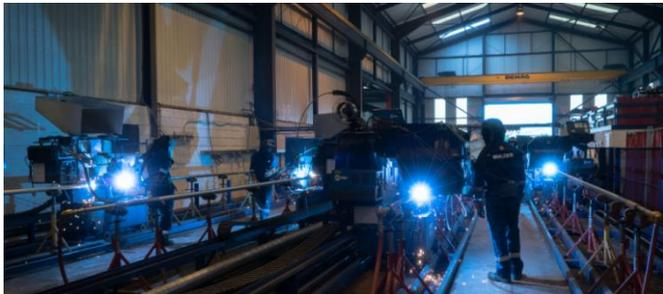
Bild 1: Auftragschweißen von Kesselrohren
