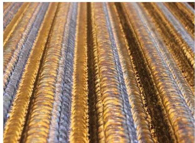
Bild 3: Auftragschweißung von einer Rohr-Steg-Rohr-Wand
