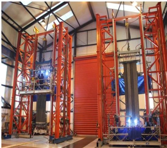
Bild 1: MSG-Impuls Rohr-Steg-Rohr-Wand-Schweißanlagen
