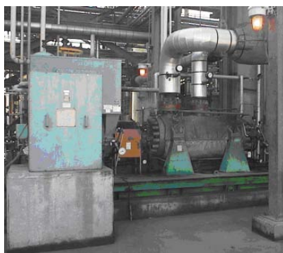
Работа насоса на площадке после модернизации и повышения рабочих параметров
