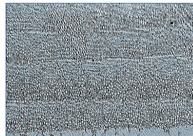
7 ■ Epitaktisches Wachstum bei der gerichtet erstarrten Superlegierung MarM002.
