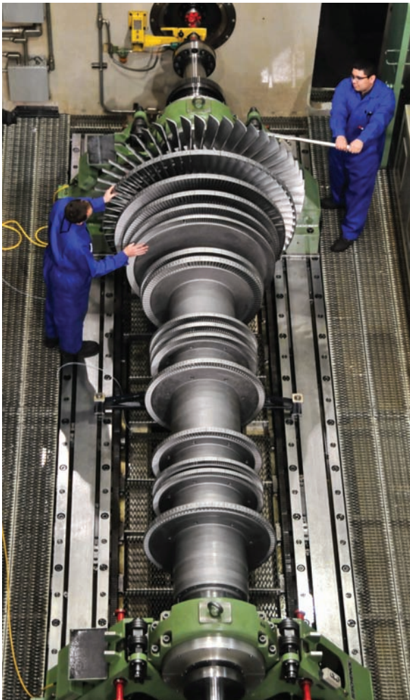
4 Hochoberhalb der ersten kritischen Drehzahl, typisch für den Typ, der ein Auswuchten mit hohen Drehzahlen verlangt.
