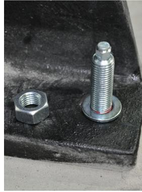
Figura 9c: Colocar la arandela
