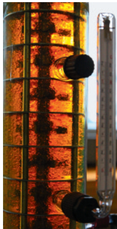
3 Gerührte Kolonne für die Flüssig-Flüssig-Extraktion im Pilotmaßstab.
