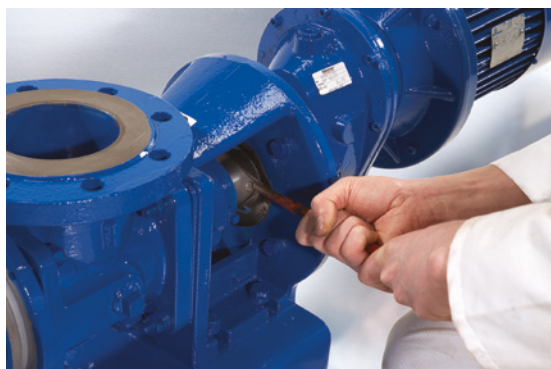
5. O acoplamento dividido é montado através de parafusos
