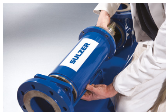
4. Todos os componentes de desgaste são facilmente removidos
