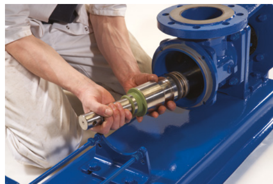
6. Solte o rotor do eixo de transmissão
