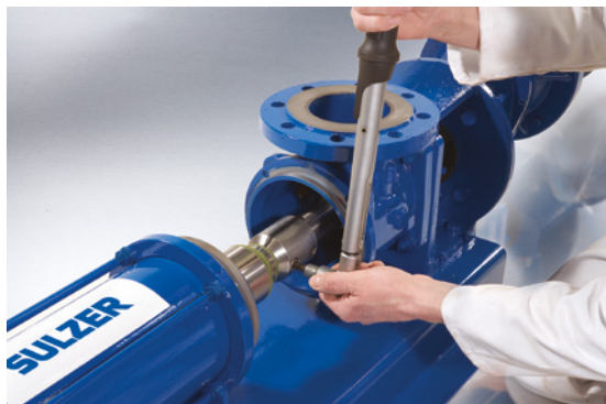
1. Com o estator e o rotor removidos, acesse a unidade
