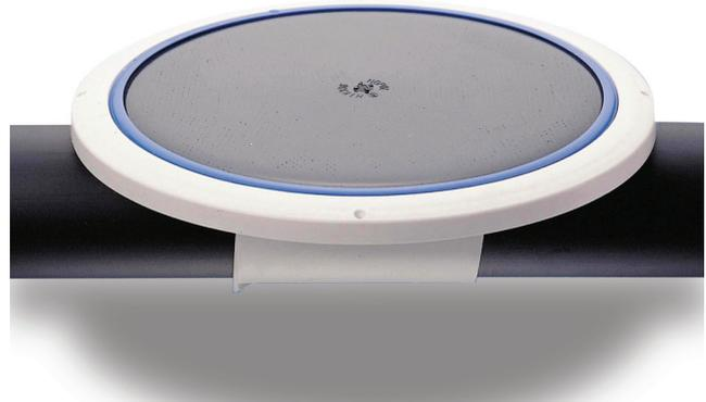
Beim Ausschalten der Luftzufuhr presst der Druck der Wassersäule die Membran fest gegen das Hauptgehäuse, dadurch schließen sich die kleinen Schlitze in der Membran. Das Rückschlagventil, bei dem eine Edelstahlkugel fest gegen eine O-Ring-Dichtung gedrückt wird, verhindert, dass Wasser in die Rohrleitung eintritt. Im Normalbetrieb dient das Rückschlagventil auch der Steuerung.
