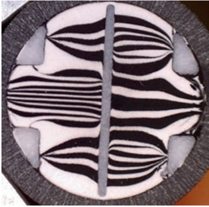
Bild 3 > Typische Mischstruktur bei statischem (links) im Vergleich zum dynamischen Mischen (rechts); dynamisches Mischen ermöglicht ein mehrdimensionales Mischen und Dispergieren
