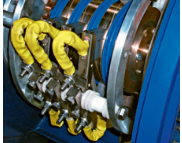
2 Nachdem Sulzer den Schleifring und den Bürstenapparat erneuert hatte, wurde die Windkraftanlage erfolgreich mit dem Netz synchronisiert und lieferte maximale Leistung.
