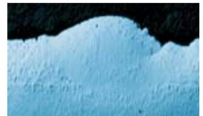
**3** Gefüge einer simulierten Reparatur-Schweißnaht nach Entspannungs-wärmebehandlung (50fach vergrößert, ungeätzt).
