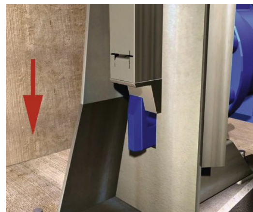
Μανδάλωση (εσωτερική όψη)
