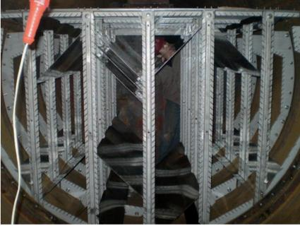
Fig. 2a: Sulzer Mellaplate W
