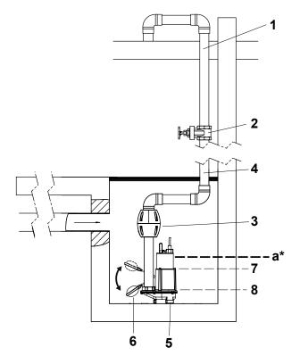
Figure 2 Exemple d'installation, puits collecteur en béton
