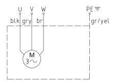
Figure 3 Câblage triphasé
