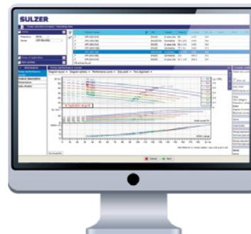
После выбора насоса можно загрузить полную информацию об изделии в формате PDF: графики производительности насоса, описание изделия, чертежи с размерами, расчеты эксплуатационных расходов и листы технических данных. Также с помощью функции PipeCalc можно выполнить расчет потерь на трение для «сухой» и «мокрой» установки.
