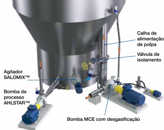
Fig. 23. Configuração do sistema de bombeamento paralelo MC.
