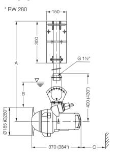
**A** = max. 2 m **B** = min. 400 mm **C** = min. 450 mm
