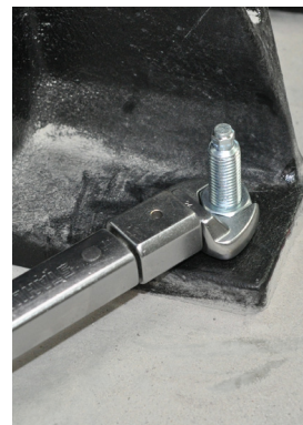
Изображение 9d: Затягане на гайката
