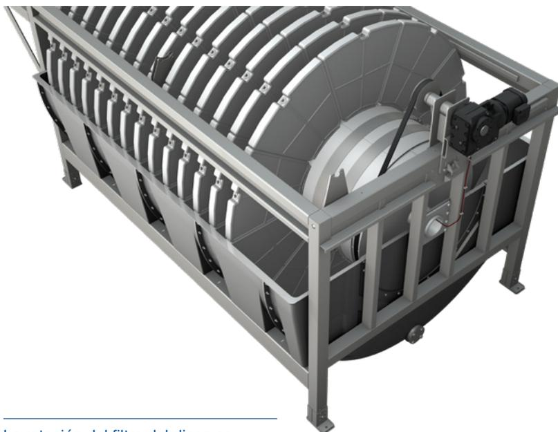
La rotación del filtro del disco es accionada por un propulsor de engranaje cónico helicoidal por medio de una correa dentada sincrónica y no corrosiva, reforzada con fibra de carbono.
