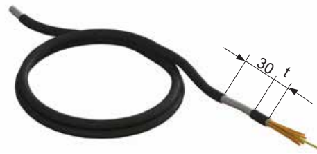
Bild 25 Avisolera 30 mm på EMC-kabeln innan den ansluts på kabelklämplattan. Måttet "t" motsvarar ca avståndet från fästklammern till kabelklämman
