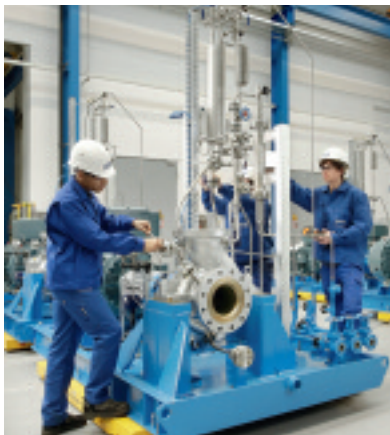
[4] Die Pumpe vom Typ ZF wird als Kesselumwälzpumpe in Kraftwerken eingesetzt. Sie kann einen Druck von bis zu 100 bar erzeugen und Flüssigkeiten mit einer Temperatur von bis zu 450 °C fördern.
