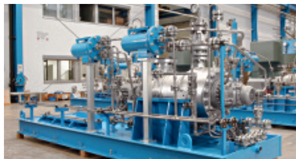
3 Die Kesselspeisepumpe GSG ist eine mehrstufige, horizontale, radial geteilte Diffusorpumpe mit Topfgehäuse. Sie kann einen Druck von bis zu 300 bar erzeugen und Flüssigkeiten mit einer Temperatur von bis zu 425 °C fördern.
