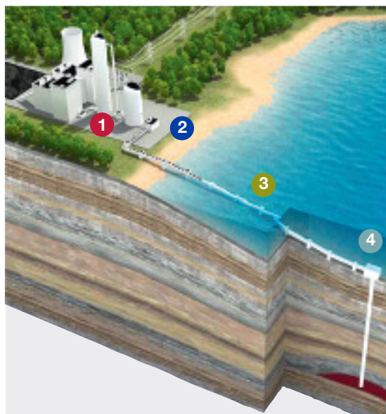
Der Grundgedanke von CCS besteht darin, das von fossil befeuerten Kraftwerken oder von CO 2 -intensiven Industrieanlagen (z.B. Raffinerien oder Zementwerke) freigesetzte CO 2 aufzufangen, zu verdichten und einzulagern.
