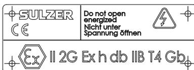
Slika 2 Označna pločica ATEX
