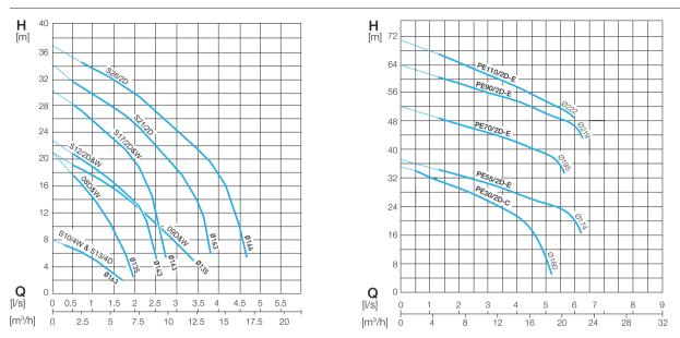
H = Hauteur manométrique totale Q = Débit Courbes de performance conformes ISO 9906 (60 Hz disponible sur demande). N.B. : le programme ABSEL doit être utilisé pour valider le choix de la pompe.
