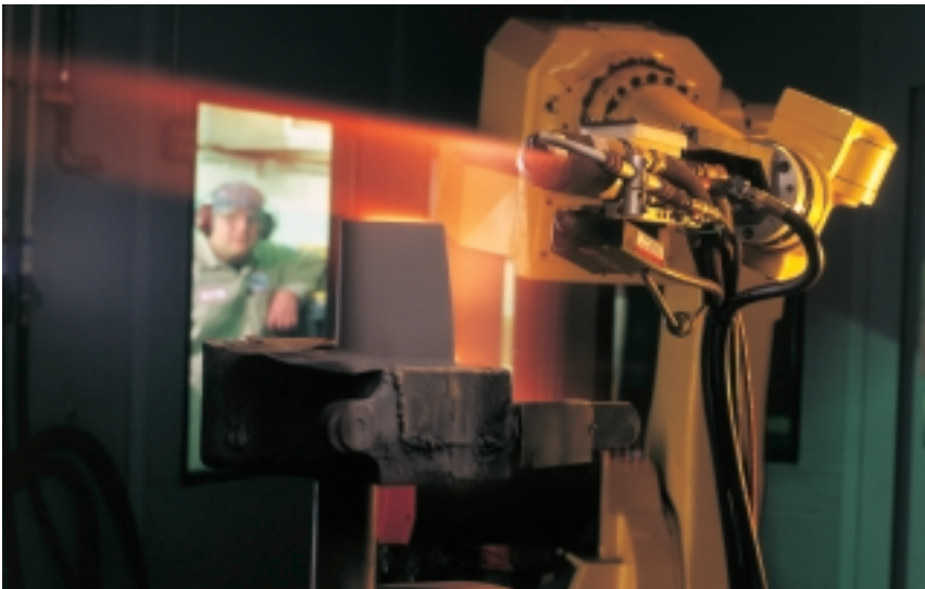
5 ■ Eine Gasturbinenschaufel erhält eine HVOF-Beschichtung. Bei Hickham werden hierfür zwei Industrieroboter von Sulzer Metco eingesetzt.
