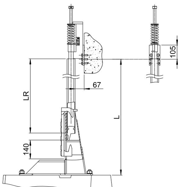
Figura 10: Determinazione della lunghezza  $L_R$  versione L + M
