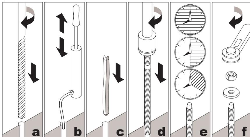
Figura 3: Montaggio dello zoccolo con barre filettate M 16
