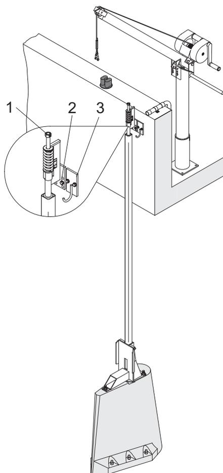
Figura 13: Supporto del tubo, gancio del cavo.
