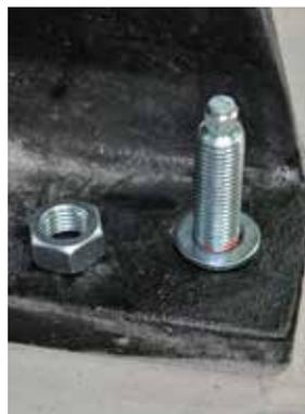
Figura 9c: Colocar la arandela
