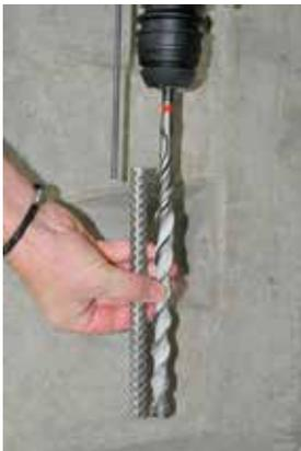
Figura 5a: Ajustar la profundidad de perforación
