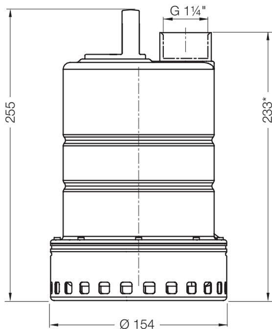
\* Druckleitungsadapterset: 310 mm (bei Austausch einer vorhandenen Coronada 200)
