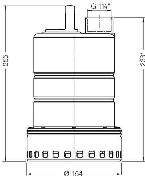
\* Con kit adattatore mandata: 310 mm (per la sostituzione di Coronada 200)
