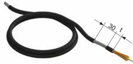
Afbeelding 25 Isolatie van de EMC kabel voor de aansluiting op de kabelklemmenplaat 30 mm verwijderen. Maat „t“ komt ongeveer overeen met de afstand van de bevestigingsklem t.o.v. de kabelklem
