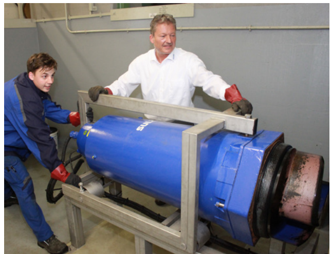
Anschließend kann das Motorgehäuse von einer Person zurückgezogen werden. Danach ist die innere Hydraulik mit Kreiselkammer und Laufrad bequem zugänglich.
