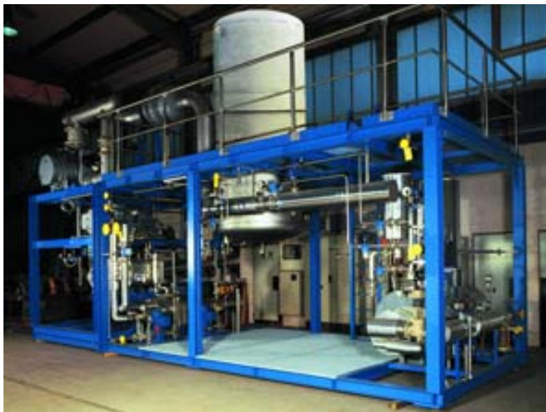
2 Die Vormontage einer Pervaporationsanlage erleichtert die Installation auf der Baustelle.
