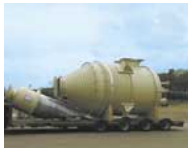
5 Entspannungskessel einer Sulzer-Devoli-Anlage auf dem Weg zum Kunden.
