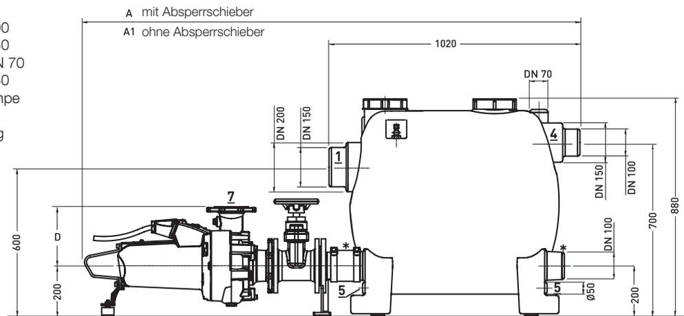
\* Diese Stützen sind nur zum Anschluss von Pumpen und nicht als Behälterzulauf geeignet.
