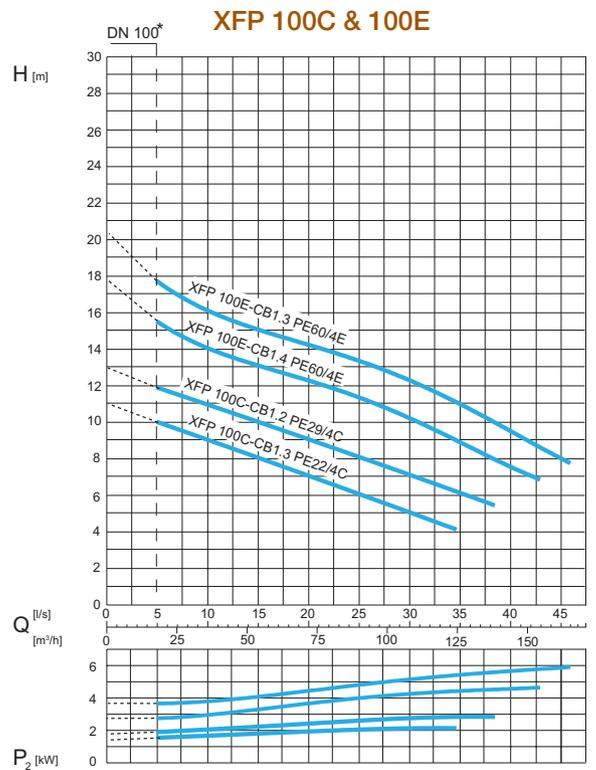
\* Einsatzgrenze Q<sub>min</sub>, H = Gesamtförderhöhe, Q = Förderstrom, Kennlinien nach ISO 9906.
