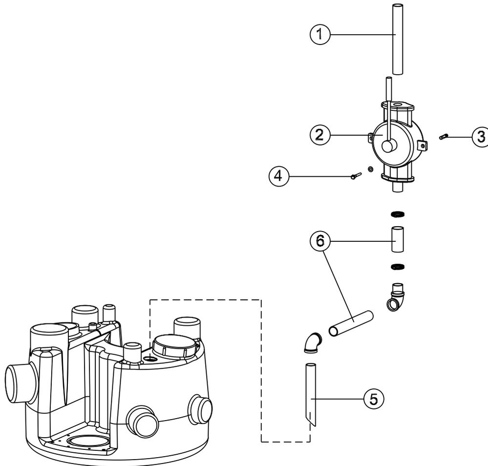
Figura 17 Installazione della pompa a membrana manuale
