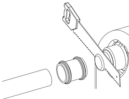
Figura 12 Apertura delle connessioni sul serbatoio di raccolta
