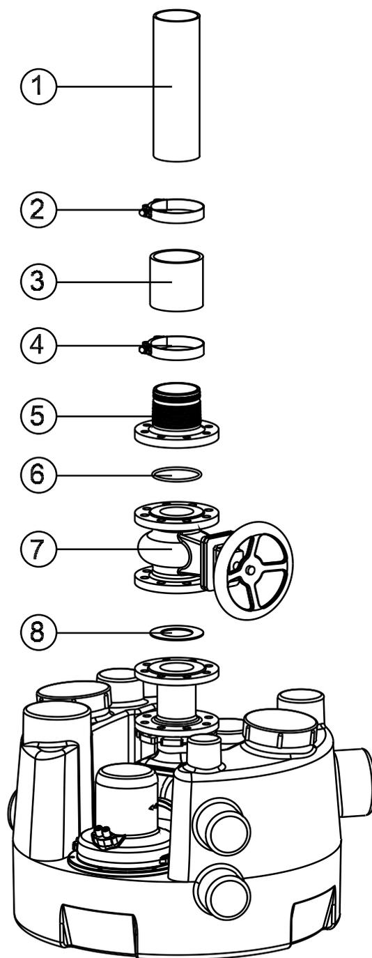
Figura 16 Installazione della valvola di arresto e del manicotto flangiato
