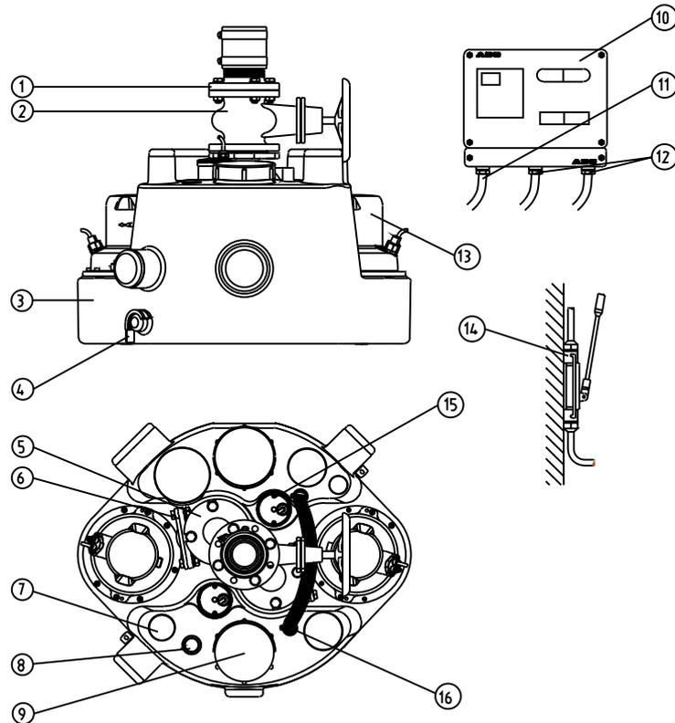
Figura 4 Struttura della postazione di sollevamento per materia fecale Sanimat/Piranhamat 1002
