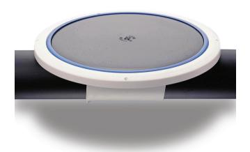
Cuando se apaga el caudal de aire, la presión del agua situada encima aprieta el disco de la membrana firmemente contra el cuerpo principal para cerrar las pequeñas rendijas en la membrana. La válvula de retención con bola de acero inoxidable presionada firmemente contra un sello con junta tórica en el interior garantiza que no se introduzca agua en la tubería. Durante el funcionamiento normal la válvula de retención también actúa como un orificio de control.
