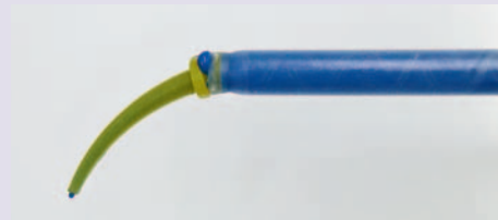
Austretendes Material zwischen Mischer und Applikationsdüse
