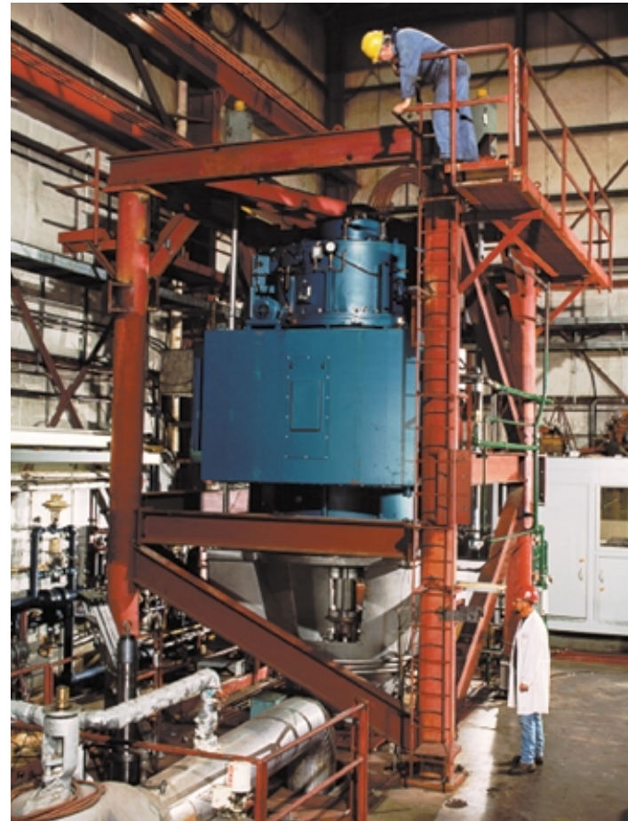
3 ■ Die hochmoderne Testeinrichtung von Sulzer in Burnaby, im kanadischen British Columbia, ist auf den nordamerikanischen Markt ausgerichtet. Der Prüfstand wurde für die Prüfung von Hochenergiepumpen in 50- und 60-Hertz-Konfigurationen entwickelt.
