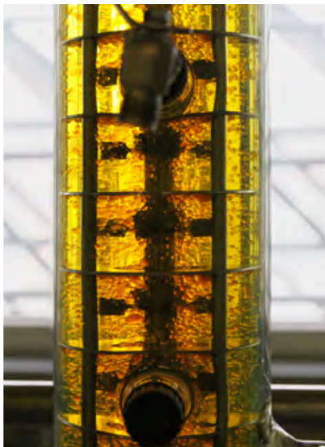
Abb. 2 DAE-Tröpfchenverteilung in der gerührten Kühni-Kolonne (ECR).
