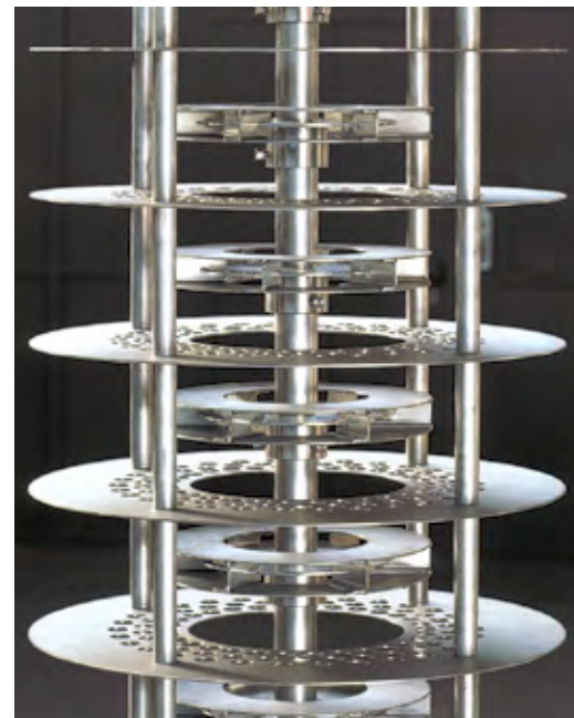
Abb. 3 Die Einbauten der gerührten Kühni-Kolonne werden auf Kundenbedürfnisse zugeschnitten.
