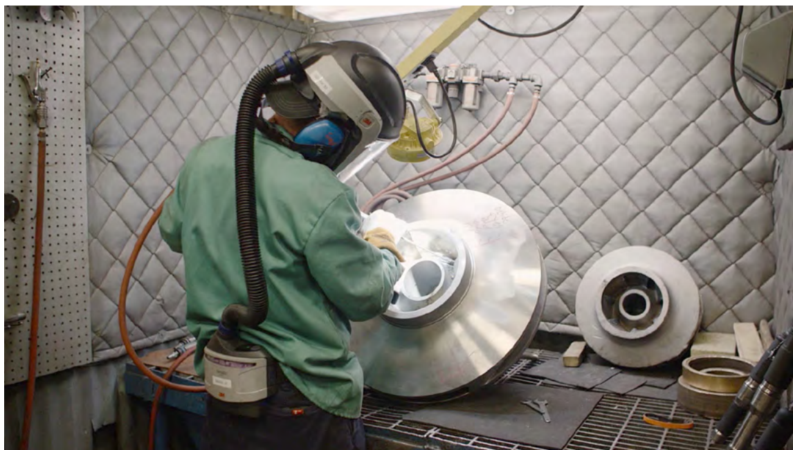
Abb. 4 Spezialanlagen zum Reinigen und Polieren vervollständigen den Prozess.
