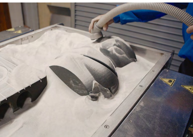
Abb. 2 Fertigung neuer Bauteile mithilfe einer 3-D-gedruckten Sandform.
