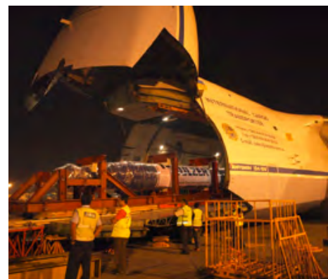
7 Transport des Generators mit einer Antonow An-124.
