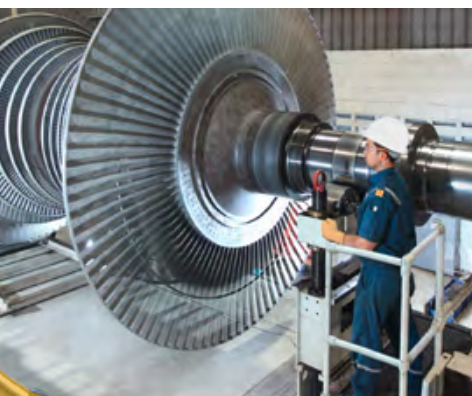
5 Auswuchten aller Komponenten vor dem Rücktransport.
