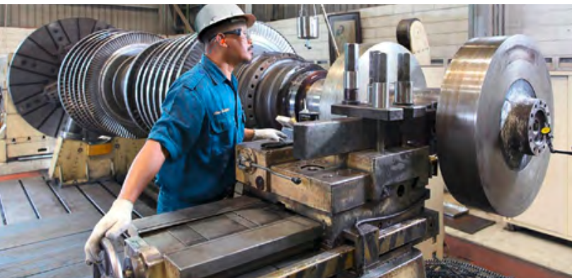
3 Am HDMD-Rotor waren eine umfangreiche Bearbeitung und Auftragschweissen erforderlich.
