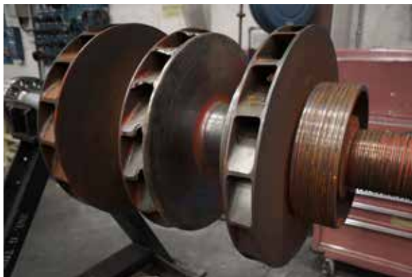
2 Schwere Schäden am Laufrad der zweiten Stufe und an den Labyrinthdichtungen.
