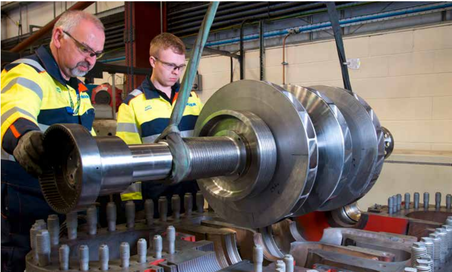
1 Endkontrolle des instand gesetzten Verdichters in Leeds.
