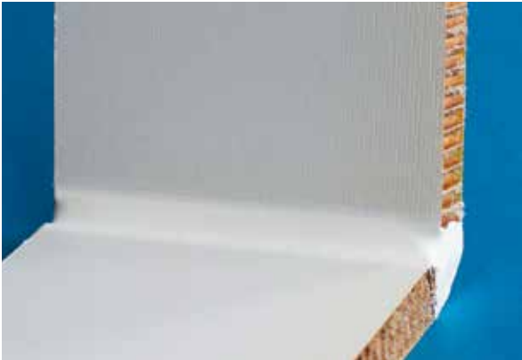
2 Faserverbund-Sandwichpanel von FACC Operations, verklebt mit dem 2-K-Epoxidharz-Klebstoff DELO-DUOPOX AB8390 von DELO Industrie Klebstoffe. (Bildquelle: DELO)
