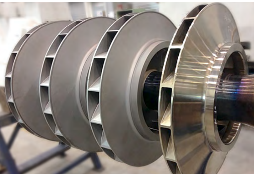
5 Repariert in Rotterdam – der Rotor mit einem neuen Laufrad.
