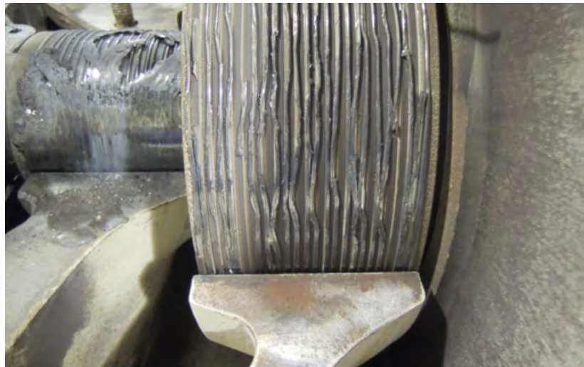
3 Labyrinth von Welle und Ausgleichskolben.
