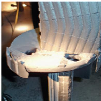
2 Schäden durch Abrasion an einem Flansch.
