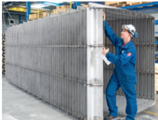
[1] Der herkömmliche Schoepentoeter ist eines der wirksamsten Systeme für die industrielle Gas-Flüssigkeits-Abscheidung, wenn nicht mehr als 95% der Flüssigkeit aus dem Gasstrom abgeschieden werden müssen.
