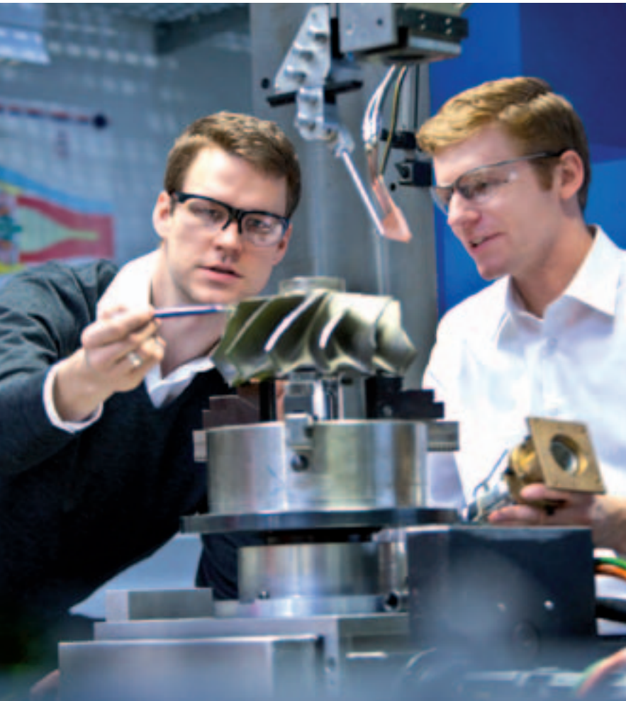
Sulzer Innotec hat ein mobiles hochpräzises Lasersystem entwickelt, das Laserauftragsschweissen mit fünf Achsen simultan ermöglicht.
