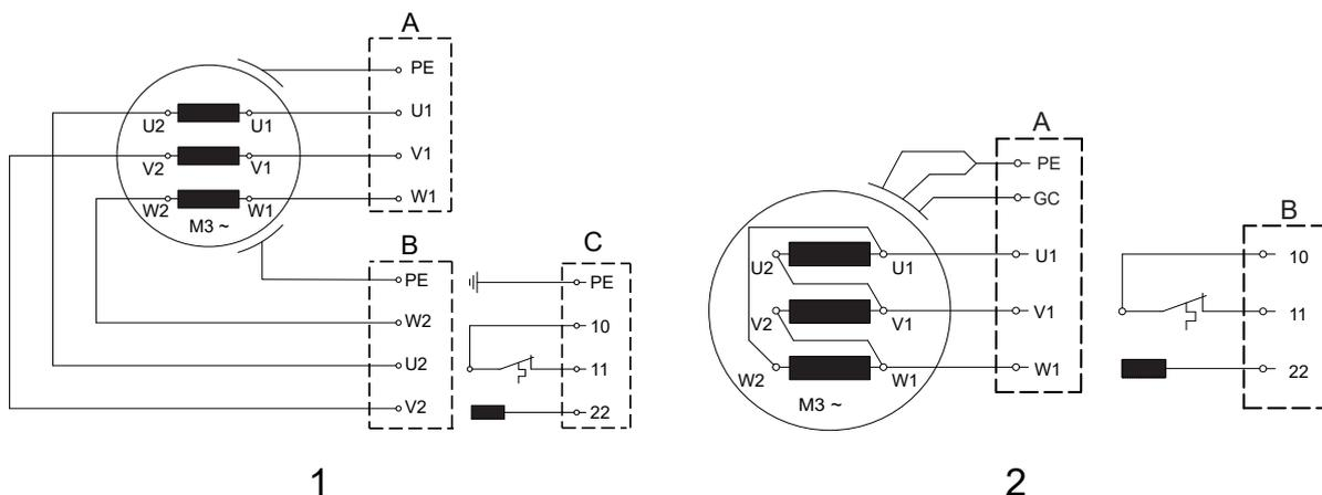
Фиг. 14. (3) 50 Hz специални версии: два захранващи кабеля и един кабел за управление – за допълнителните функции за следене на двигателя.
