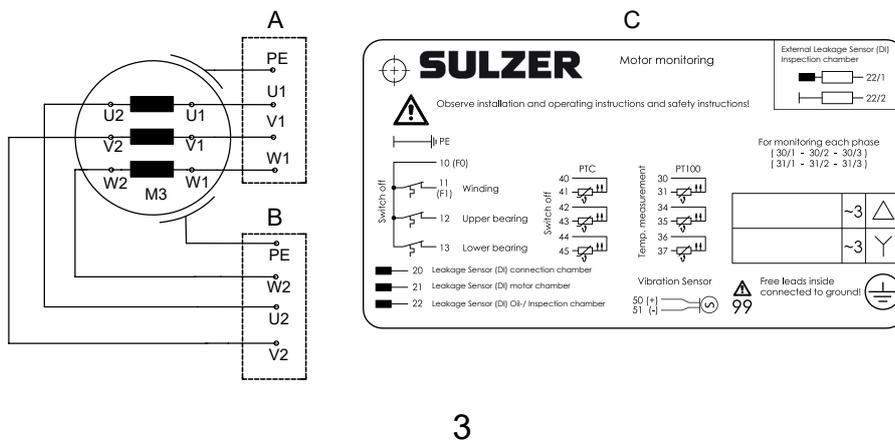
Фиг. 15. (4) 60 Hz: един захранващ кабел и един кабел за управление – за допълнителните функции за следене на двигателя.
